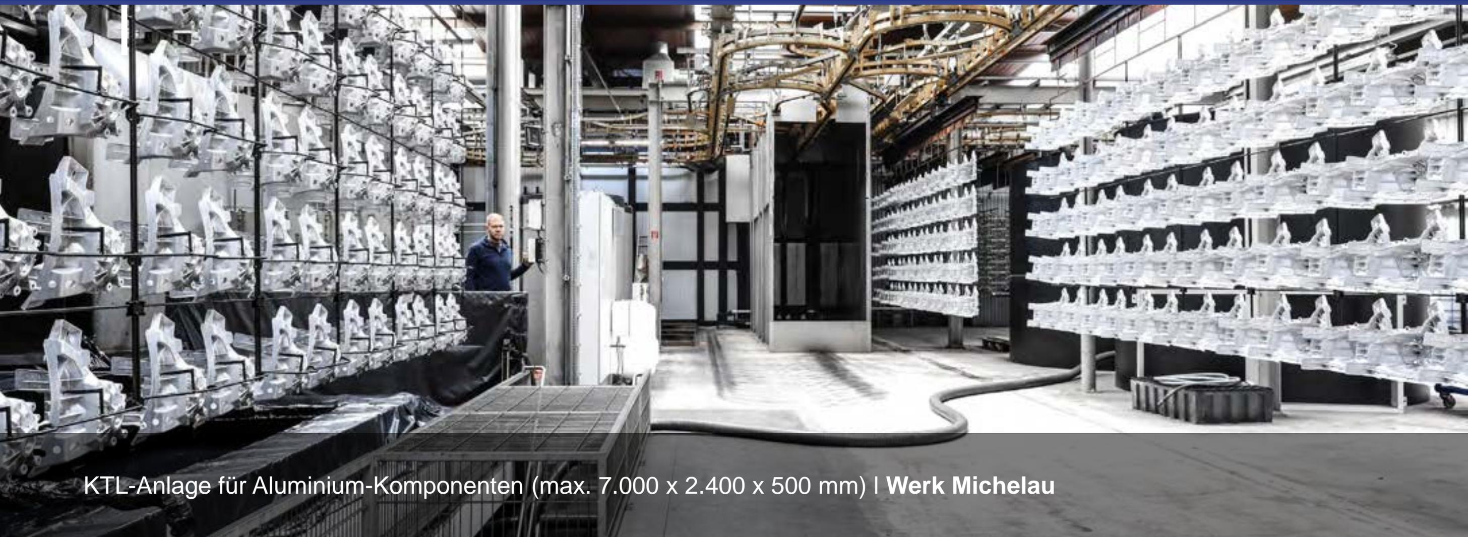
KTL-Anlage für Aluminium-Komponenten (max. 7.000 x 2.400 x 500 mm) | Werk Michelau
